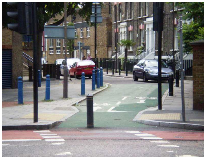
Fotografia 27. Włączenie rowerowe w ulicę nie posiadającą włączenia dla samochodów (Londyn, uwaga: ruch lewostronny)
