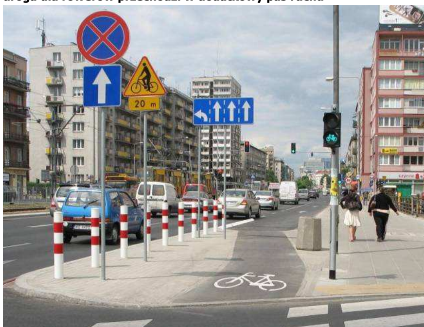
Fotografia 39. Warszawa, ul. Puławska: wzorcowe włączenie rowerowej drogi dla rowerów w jezdnię, tutaj droga dla rowerów przechodzi w dodatkowy pas ruchu
