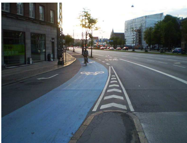
Fotografia 11. Pas dla rowerów ze służą rowerową przed skrzyżowaniem (De Steeg, Holandia)
