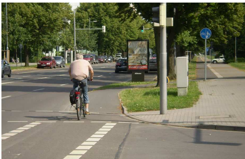
Fotografia 4. Za skrzyżowaniem pas dla rowerów znowu przekształca się w wydzieloną drogę dla rowerów i ucieka od jezdni za szpaler drzew – to samo skrzyżowanie co powyżej
